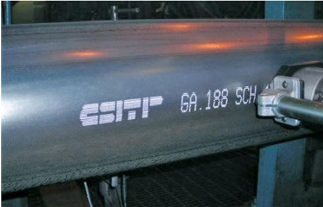
Kennzeichnung von Rohren (Stahl, Kunststoff etc.)
