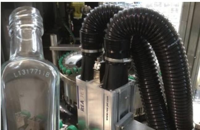
Glaskennzeichnung mit CO<sub>2</sub> Laser IP65
