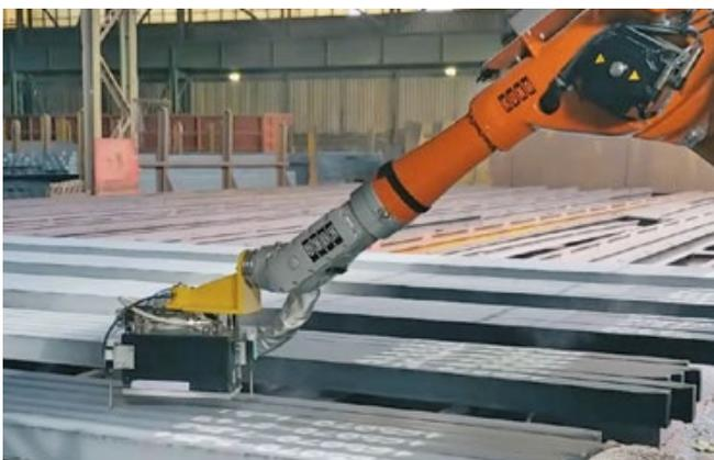
Stahlknüppelmarkierung Signierblock an Roboter
